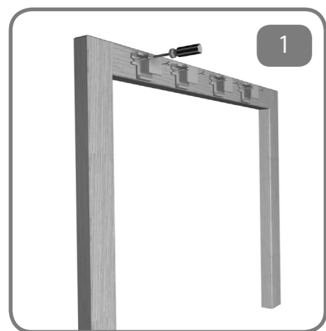
Fissare i supporti reggi guida nella parte superiore del telaio.
