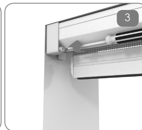
Serrare le due viti a brugola delle testate, accertandosi che le pareti siano solide.
