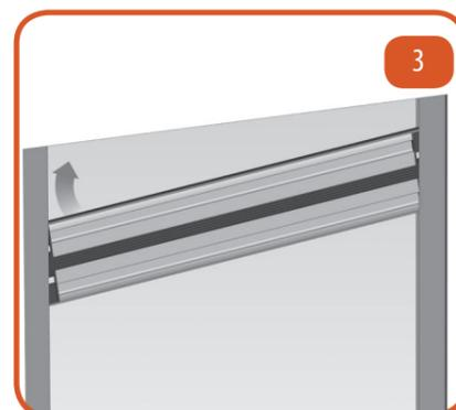
Montare il pacchetto rete inserendolo all'interno delle due guide.
