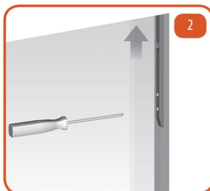
Posizionare il fermo presente all'interno delle guide nella posizione più alta possibile e bloccarlo avvitando i due grani.
