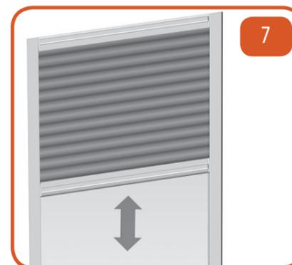
Rimuovere le fascette di carta e provare più volte l'apertura e la chiusura della zanzariera in modo da distribuire correttamente i fili. Agire nuovamente sui tensionatori per raggiungere la trazione ottimale.
