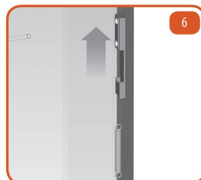
Agire sui tensionatori presenti all'interno delle guide per portare in tensione i fili. Serrare i grani del tensionatore una volta raggiunta la tensione desiderata
