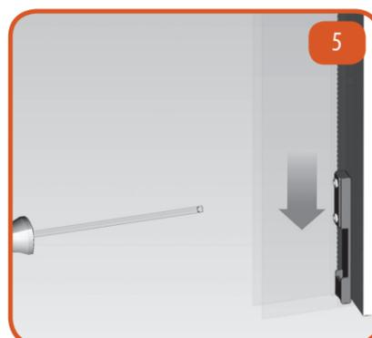
Posizionare il passafili presente all'interno delle guide nella posizione più bassa possibile e bloccarlo avvitando i due grani. **ATTENZIONE A NON TRANCIARE I FILI CON LE VITI.**
