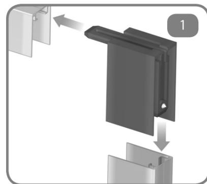
1 Montare le due cuffie autoportanti alle guide laterali e alla guida superiore.
