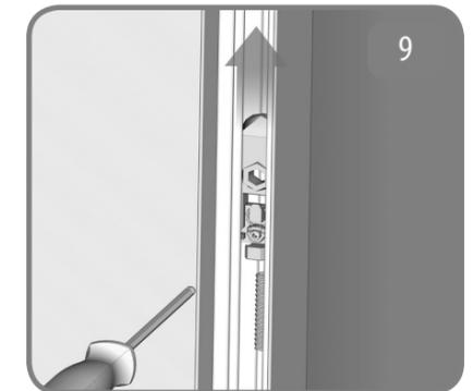
9 Agire sul tensionatore inferiore per portare in leggera tensione i fili inferiori. Serrare il grano del tensionatore una volta raggiunta la tensione desiderata. (In questa fase alcuni fili possono rimanere ancora allentati). Eseguire la stessa operazione con il tensionatore superiore.
