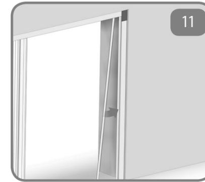
11 Posizionare ad incastro il magnete nel profilo di riscontro all'interno della guida laterale.
