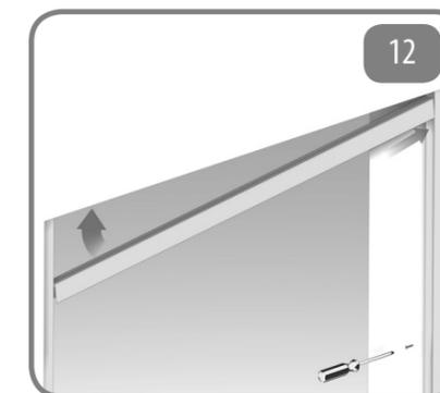
12 Nel modello 17 non sono presenti le cuffie autoportanti. E' necessario quindi fissare con le viti anche la guida superiore inserendola all'interno delle due guide laterali. Si può procedere poi al montaggio seguendo la stessa sequenza del modello 22 mm.
