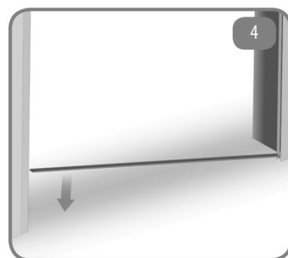
4 Rimuovere la pellicola del biadesivo e posizionare la guida inferiore
