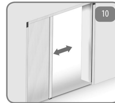
10 Rimuovere le fascette di carta e provare più volte l'apertura e la chiusura della zanzariera in modo da distribuire correttamente i fili. Agire nuovamente sui tensionatori per raggiungere la trazione ottimale.
