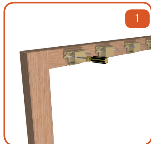
1 Fissare i supporti reggi guida nella parte superiore del telaio (disponibili in varie versioni vedi catalogo Zanzariere).
