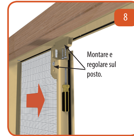
8 Posizionare il fermo superiore in modo che la barra maniglia stia a 90° col pavimento.
