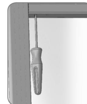
Per regolare la carica di ritorno nella zanzariera sarà sufficiente inserire il cacciavite con la testa esagonale nel foro presente sulla guida superiore (che è situato in prossimità del cassonetto, a destra o a sinistra) ed agire in senso orario o antiorario per caricare o scaricare la molla.
