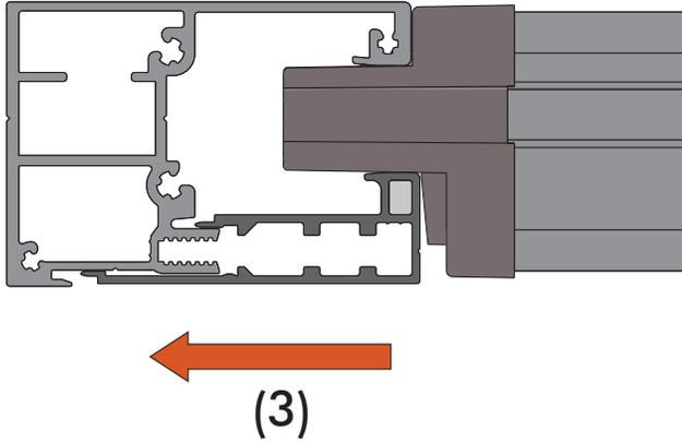
(3) Inserire il profilo nel suo alloggiamento spingendolo verso la parte fissa.
