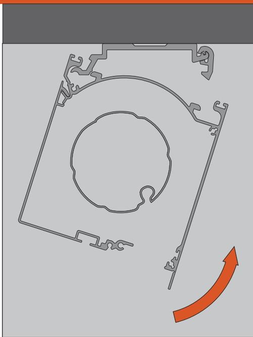
Sistema Easy Zero: Appoggiare la parte anteriore del cassonetto agli attacchi e ruotarlo fino ad agganciarlo completamente.
