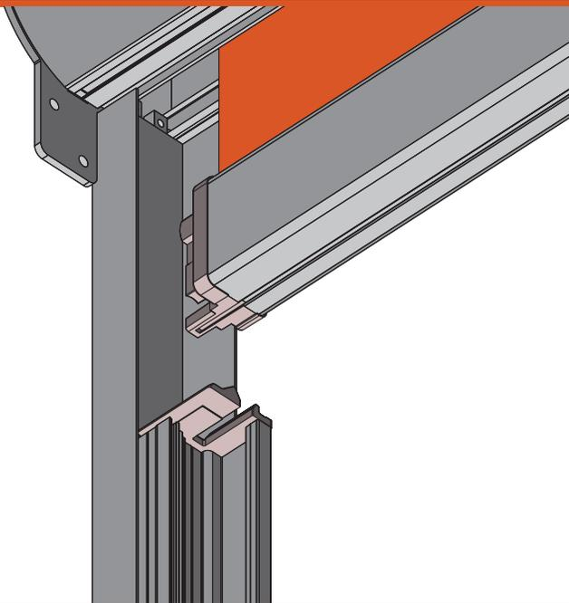
Inserire le guide regolabili all'interno dei profili "U" telescopici già installati.
