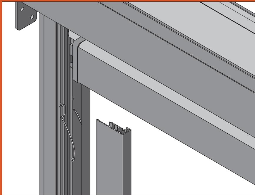
Montare i profili di copertura nelle guide laterali e fissarli con le viti fornite.
