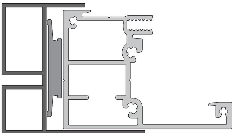
Inserire, se necessario, gli spessori per distanziare la guida dal profilo ad "U" (come mostrato in figura) e bloccarli con il biadesivo. Fissare la posizione delle guide con le viti.
