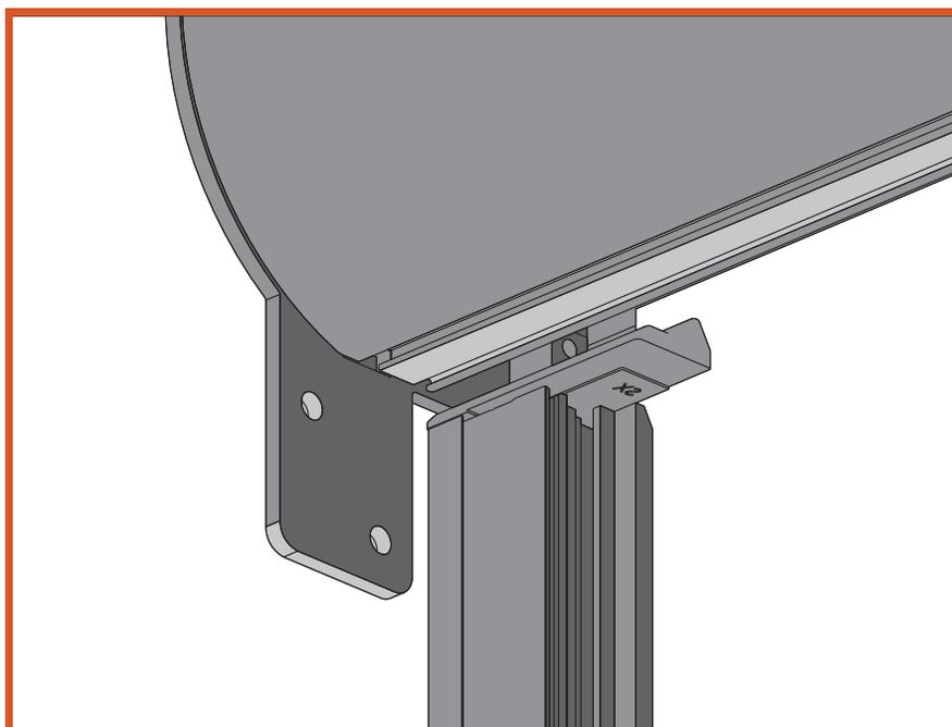
Far scorrere il profilo in PVC fino ad arrivare superiormente a battuta con l'imbocco della guida.
