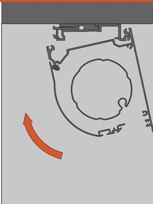
Sistema Easy Fix: Appoggiare la parte posteriore del cassonetto agli attacchi e ruotarlo fino ad agganciarlo completamente.
