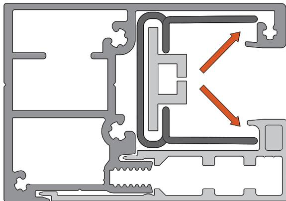
Nel montaggio delle copertine assicurarsi che i lembi esterni delle molle entrino nella posizione corretta all'interno delle estremità della guida.
