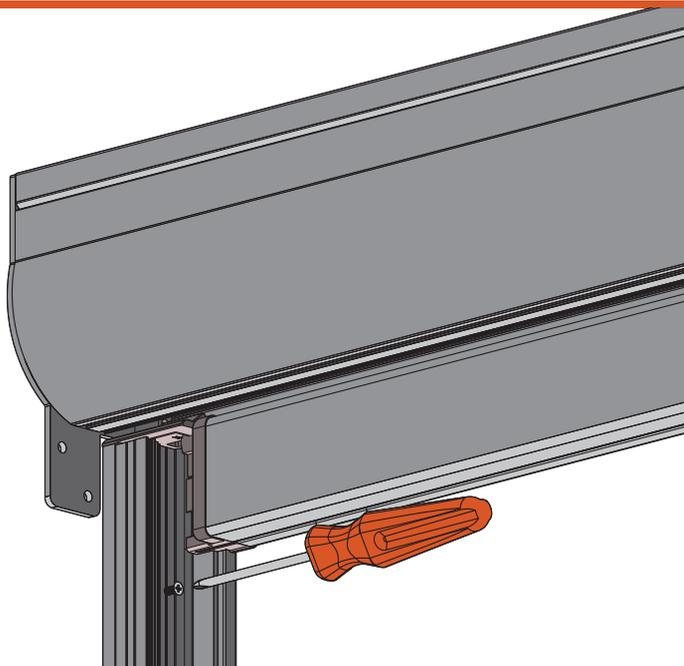
Avvitare il tenone alle guide attraverso il foro posto sulle guide in modo da rendere questi due elementi tra loro solidali
