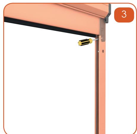
Montare i piedini nella parte inferiore delle guide laterali.
